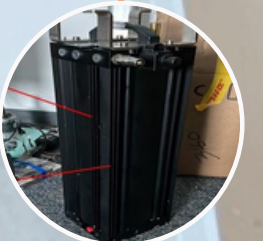
Acumulador de aceite en aluminio con bomba hidraulica de 6.3 Lts.
